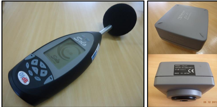
Figura 118 – Medidor de nível sonoro (MINS) e calibrador acústico utilizado.
