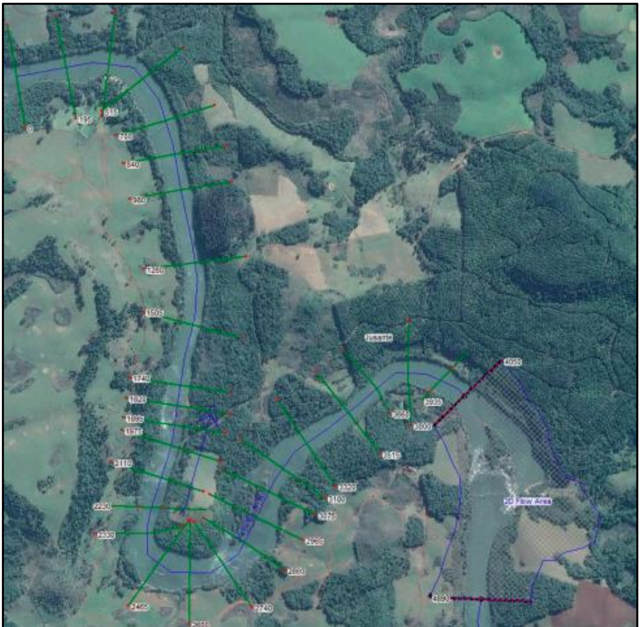
Figura 111 – Eixo e localização das seções do modelo unidimensional – jusante.
