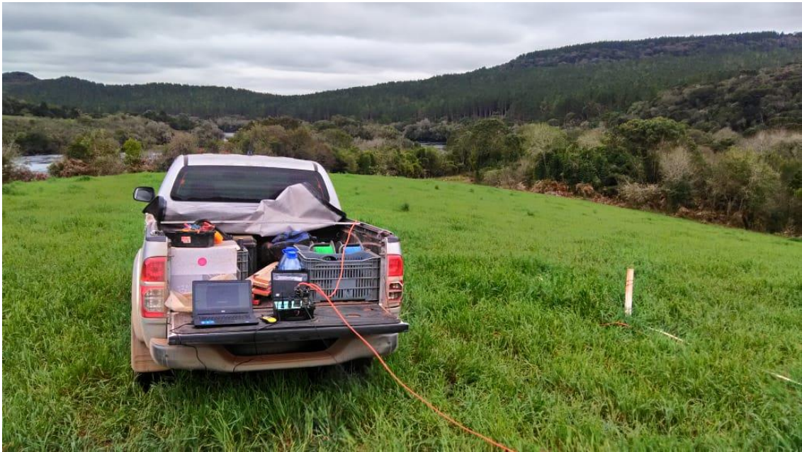
Figura 1. Levantamento geofísico de eletrorresistividade em campo.
