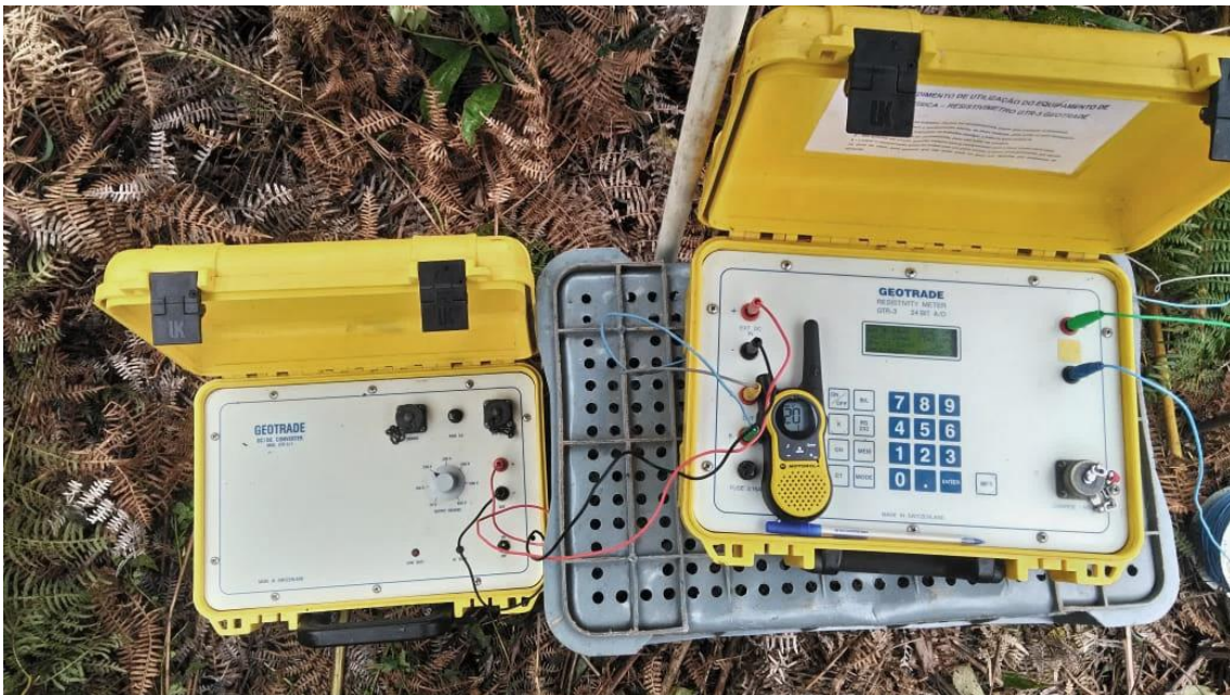
Figura 2. Equipamentos utilizados – resistímetro, conversor de voltagem e bateria.
