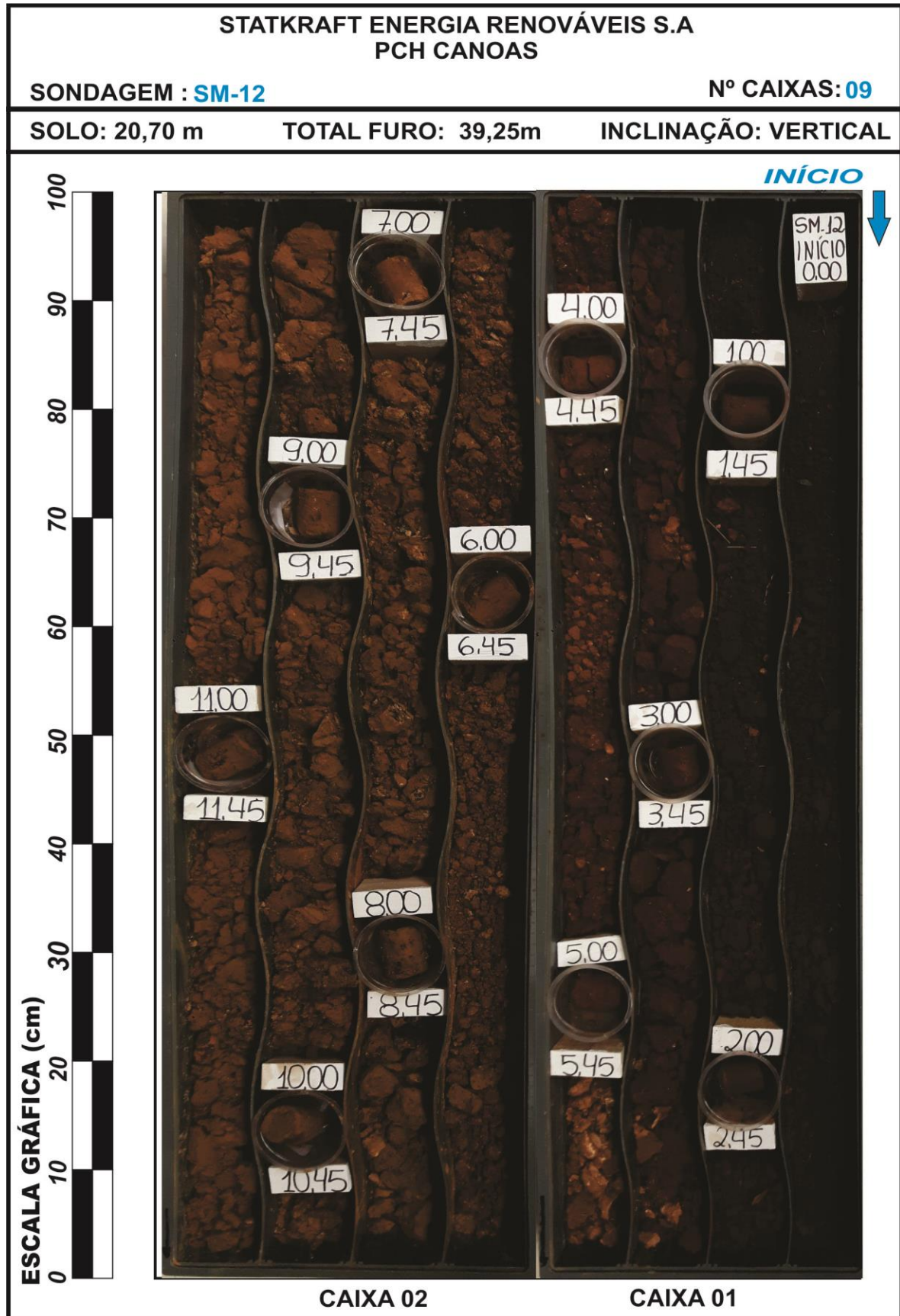
Figura 6. Registro fotográfico das amostras e testemunhos obtidos na sondagem SM-12.
