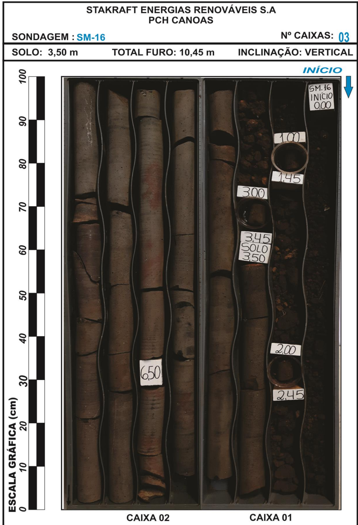
Figura 24. Registro fotográfico das amostras e testemunhos obtidos na sondagem SM-16.
