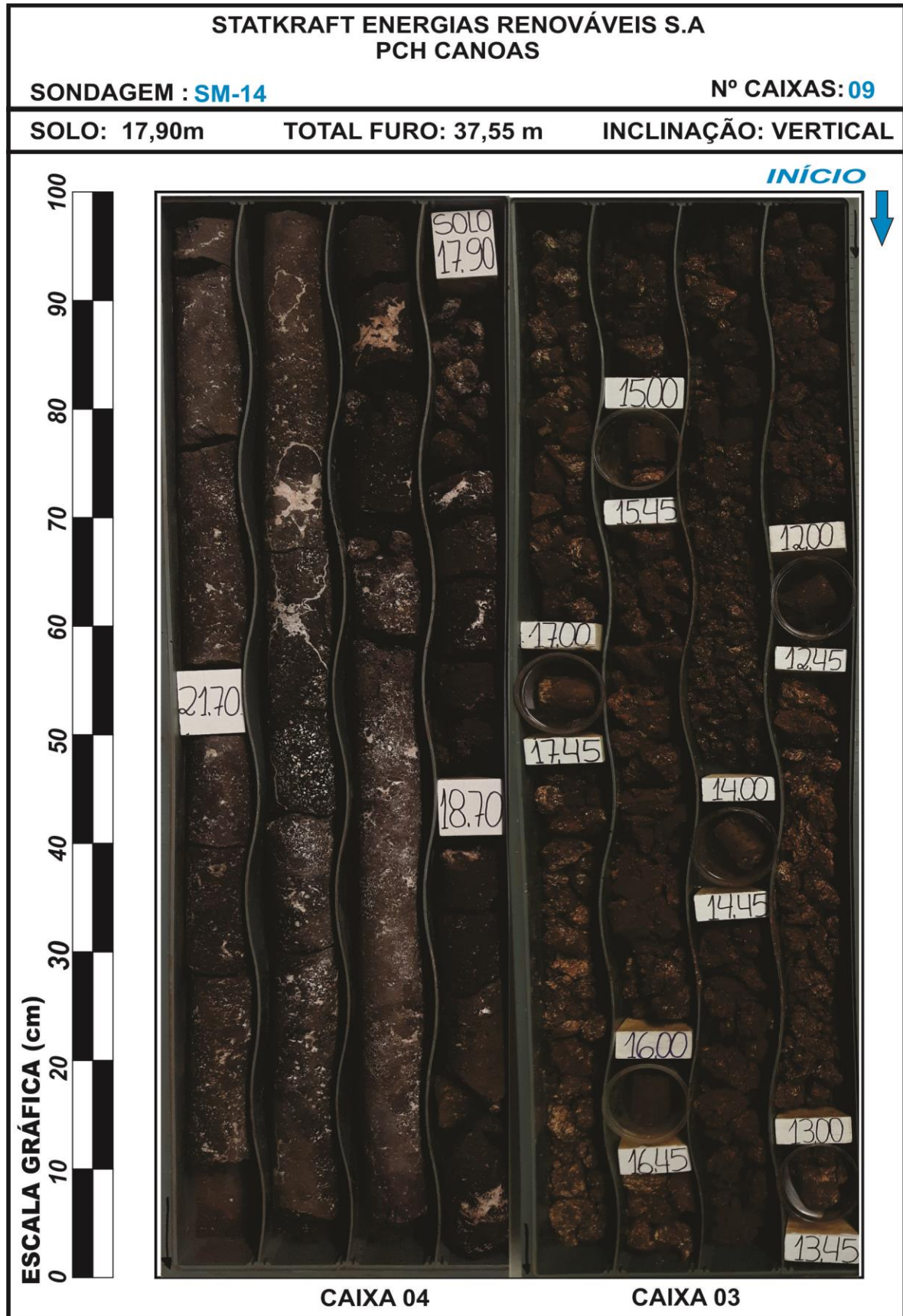
Figura 18. Registro fotográfico das amostras e testemunhos obtidos na sondagem SM-14.
