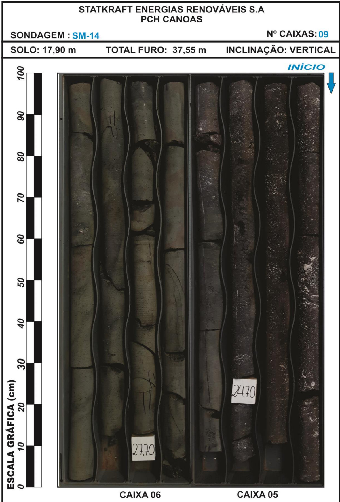
Figura 19. Registro fotográfico das amostras e testemunhos obtidos na sondagem SM-14.
