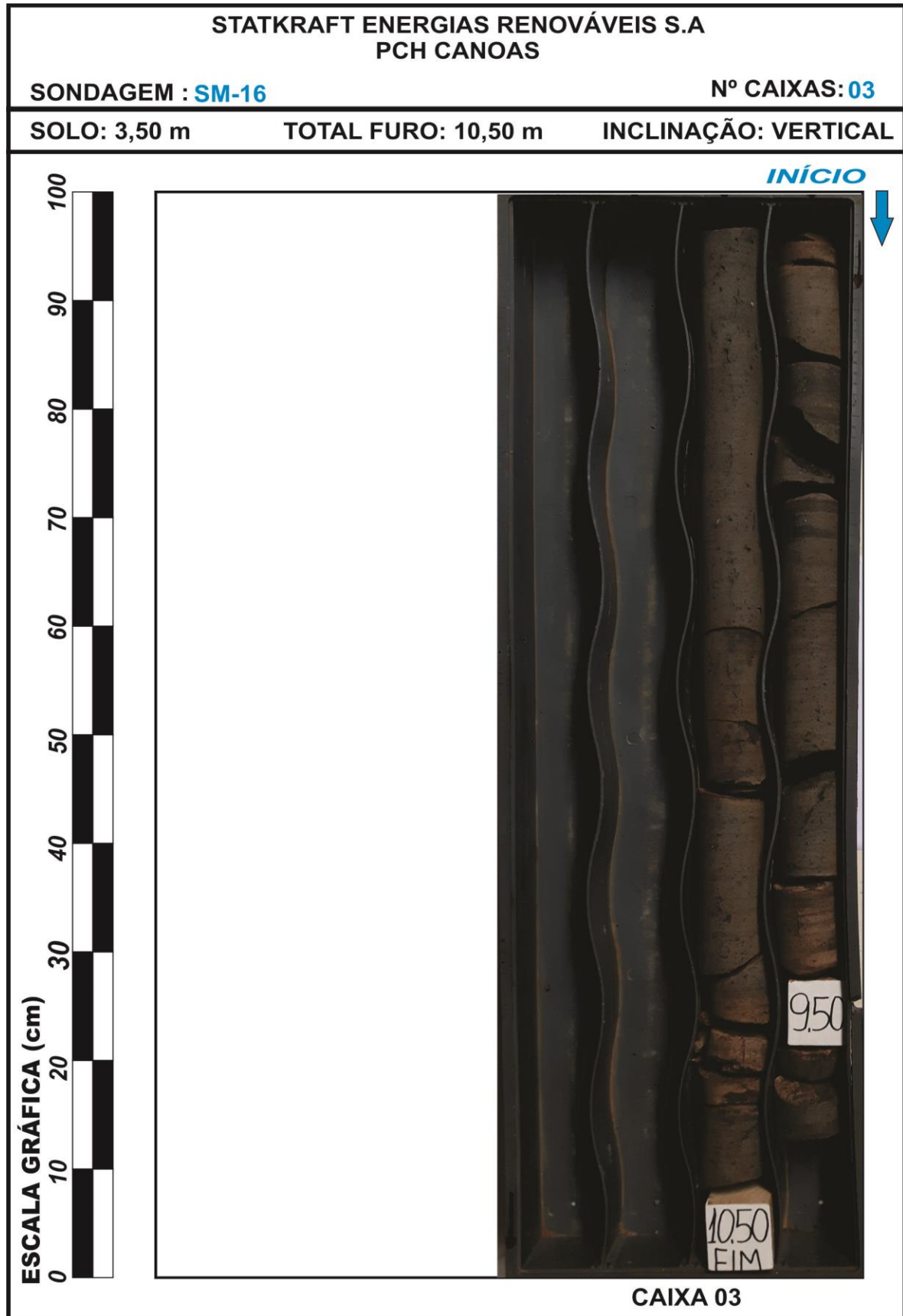
Figura 25. Registro fotográfico das amostras e testemunhos obtidos na sondagem SM-16.
