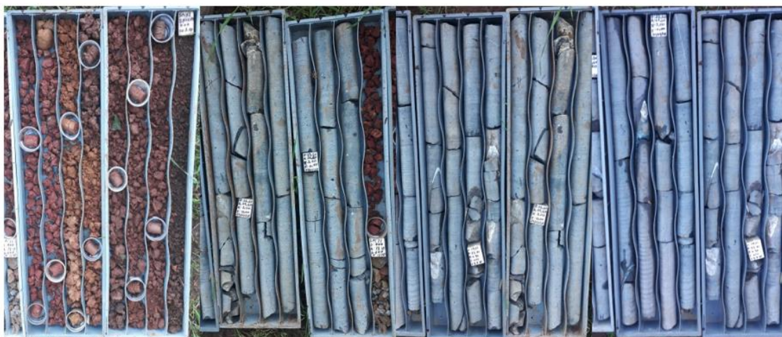
Figura 21 – Fotos em campo das caixas 1 a 6 dos testemunhos do furo SM-11
