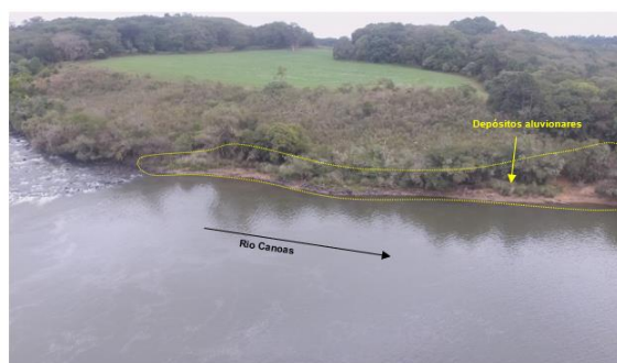
Figura 50– Foto da margem esquerda no local da PCH Canoas. Em destaque a planície aluvionar ocorre na margem, a jusante do eixo
