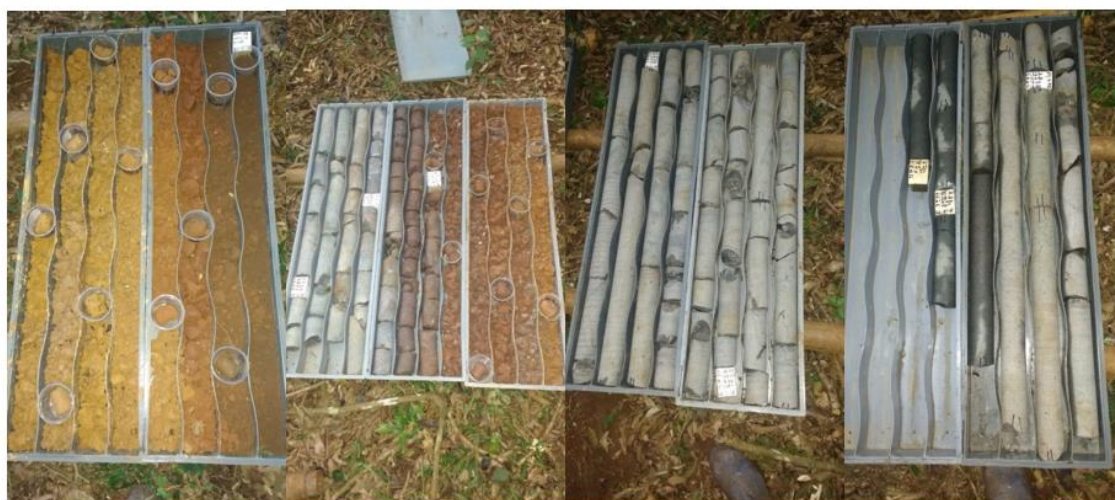
Figura 22 –Fotos em campo das caixas 1 a 9 dos testemunhos do furo SM-12
