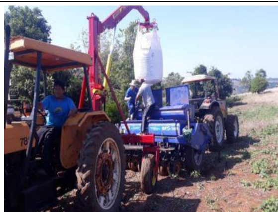
Foto 19- Carregamento das sementes na plantadeira 46 linhas.
