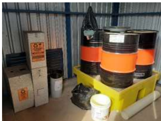
Foto 59 – Resíduos perigosos armazenados sobre bacias de contenção.
