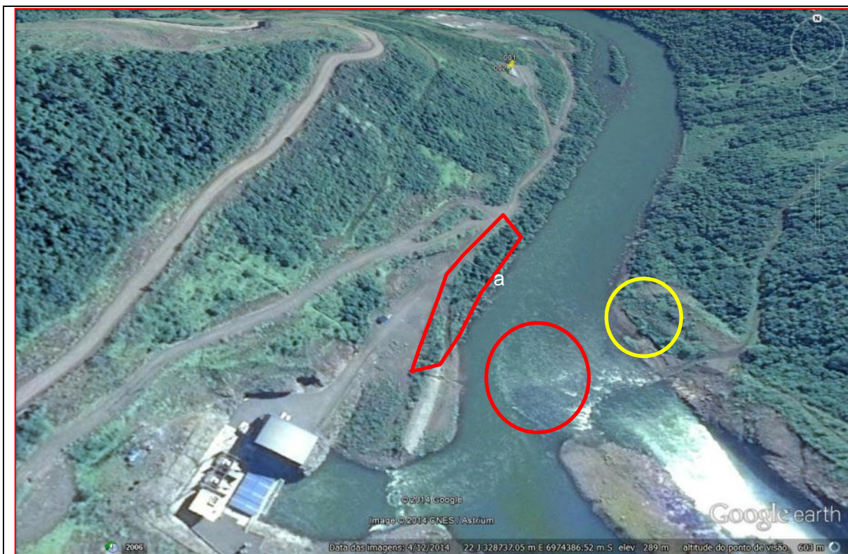
Imagem 04 – Imagem do Google Earth, com a definição dos locais afetados pelas chuvas e consequente cheia do Rio Passo Fundo a) área de mata ciliar removida pela cheia, b) área do novo depósito de rochas e área c) local onde havia um estoque de rocha que também acaba no rio.
