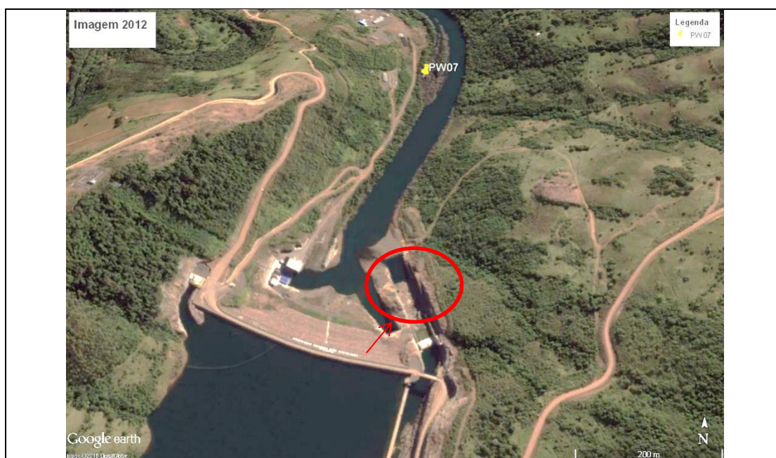
Imagem 02 – Em setembro de 2011, veio a primeira grande cheia que levou parte do bota-fora e a berma indicada na seta vermelha e parte do piso rochoso erodido do vertedouro para o leito do rio, essa imagem mostra a primeira barra formada.
