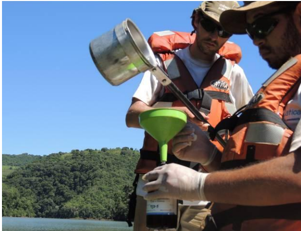
Acondicionamento de amostra de água superficial coletada no ponto MJ3.
