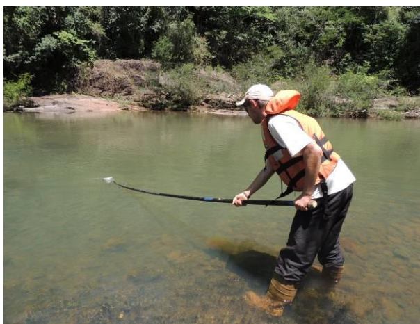
Coleta de amostra de água superficial realizada com auxílio da jarra coletora no ponto MJ1.
