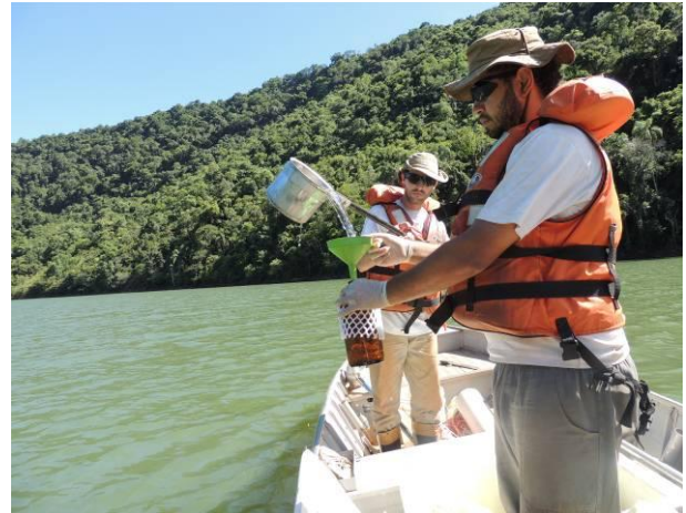
Coleta de amostra de água realizada com auxílio da jarra coletora no ponto MJ4.
