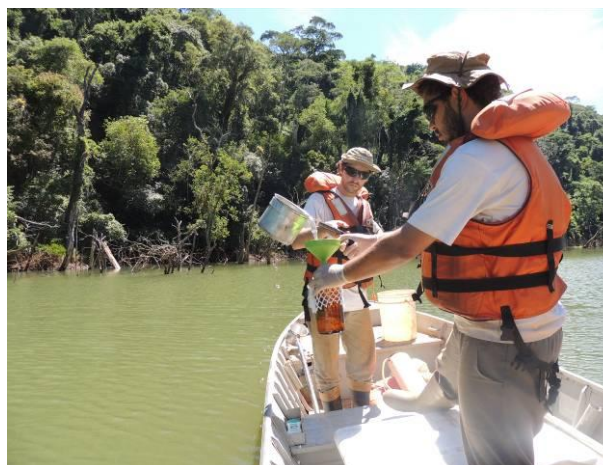
Coleta de amostra de água superficial realizada com auxílio da jarra coletora no ponto PFLent (rio Passo Fundo Reservatório).
