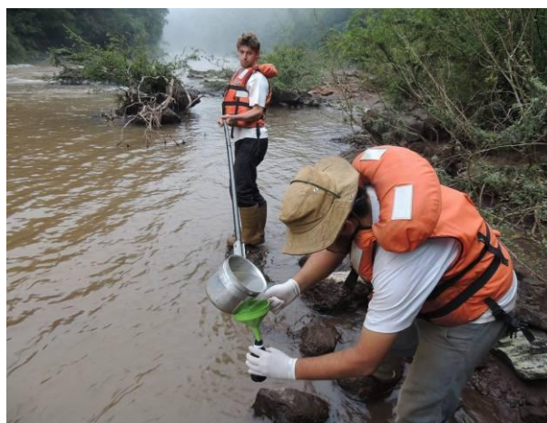
Coleta de amostra de água superficial realizada com auxílio da jarra coletora no ponto MJ2.
