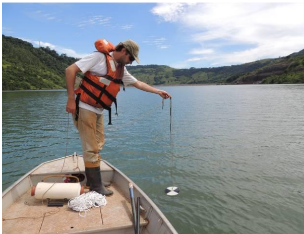
Aferição da transparência na estação amostral MJ5.
