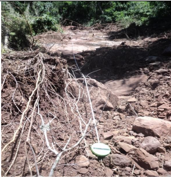
Foto 05 – Vista para montante do escorregamento mostra a corpo da rocha totalmente nu, em uma extensão de 50m. Foto 06 – Vista de jusante demonstra um afunilamento rumo a drenagem original com todo o material que foi lavado, a área total do escorregamento é de cerca de 840m 2 .
