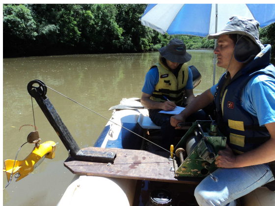
Foto 2: Medição de sedimentos em suspensão na estação Cruzaltense Montante, em nov/13 .
