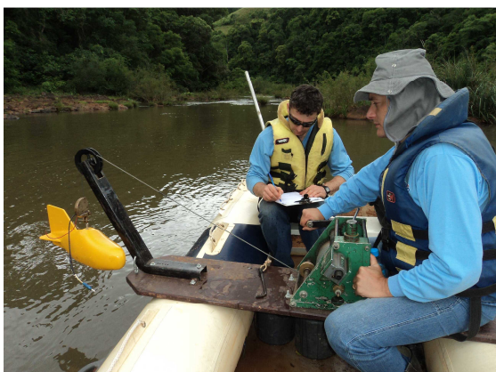
Foto 5: Tentativa de amostragem de sedimentos de leito na estação Nonoai Montante, sem sucesso, em nov/13.
